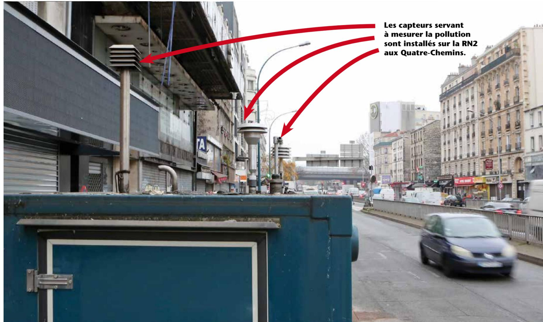
Les capteurs servant à mesurer la pollution sont installés sur la RN2 aux Quatre-Chemins.
